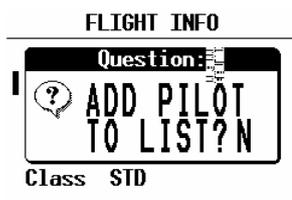
Im LX7007 können bis zu 30 Piloten abgespeichert werden. Unter dem Namen des Piloten werden die von Ihm gewählten Einstellungen mit abgespeichert. Zusätzlich kann er diese Settings noch mit einem Passwort schützen. Für mehr Informationen zum Thema Pilotenliste siehe Kapitel 3.3.2.9.
