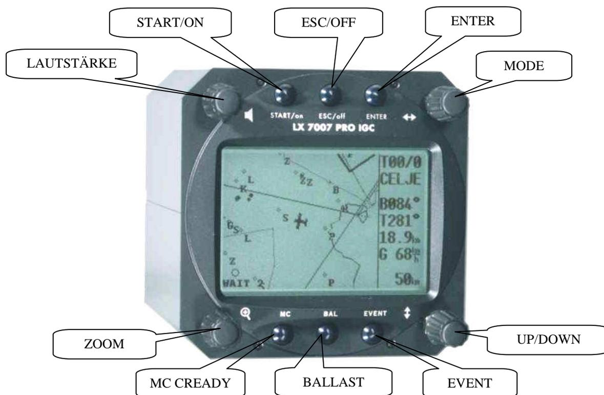
Die Varioanzeige (LX7007 AU) besitzt keine Bedienelemente, d.h. alle notwendigen Eingaben werden am Rechnermodul (LX7007 DU) durchgeführt.
