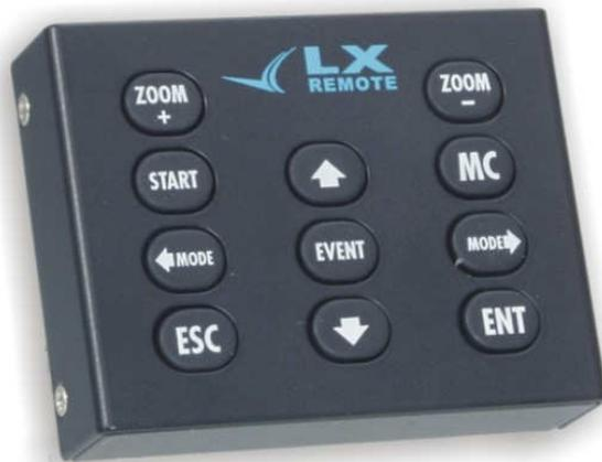
Alle 11 Tasten sind nur einfach belegt, das bedeutet es gibt keine Doppelbelegungen. Die Bedienphilosophie der Tastatur entspricht 100% der des LX7007 pro IGC.
